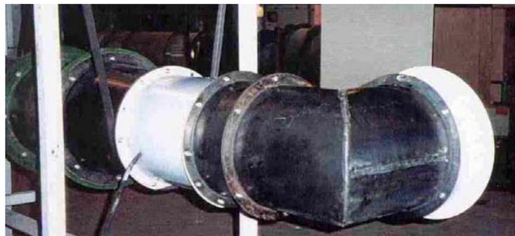
Fig. 18a Elbow at the fan inlet
